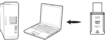
Nota: Ao usar um computador desktop, é recomendável usar uma base de cabo de extensão USB para conectar à porta na parte de trás do gabinete do computador (algumas portas de computador desktop têm fornecimento de energia insuficiente) e estendê-lo para as portas USB do computador desktop.
