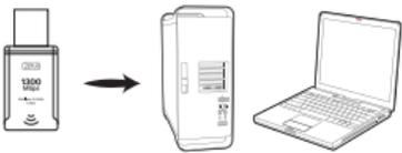
1.2 Conecte a porta USB do computador através da base do cabo de extensão USB (a base de extensão USB precisa ser adquirida separadamente).
